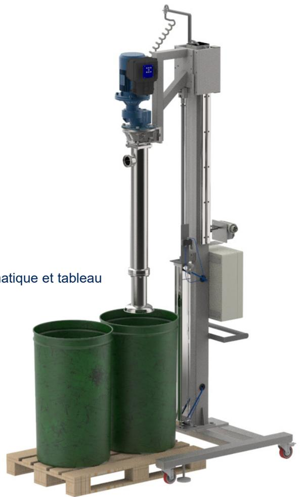
Pompe MAV avec chariot vertical pneumatique et tableau de commande électropneumatique.
