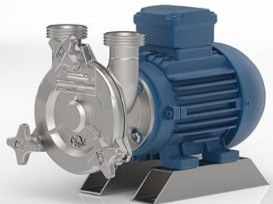
Vollständig aus Edelstahl CF-8M 1.4408 / AISI 316 gefertigt. Aus Feinguss gefertigt. Chemische Polierbehandlung. Diese Pumpe ist für verschiedene Flüssigkeiten geeignet (Säfte, Milch, Molke, Sirup, Öl, Wein und Liköre, chemische und pharmazeutische Produkte).
