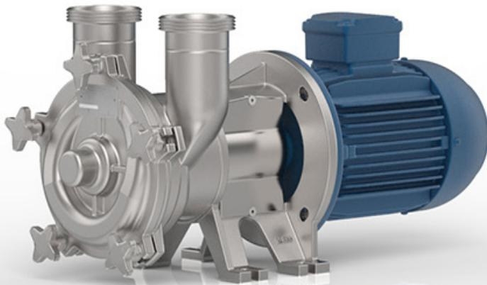
A 41 - A 51 - A 66 - A 81: Pumpen in Monoblockausführung mit separatem IEC-Motor und elastischer Kupplung. Die Pumpen können überprüft werden ohne die Saug und Druckleitung zu demontieren.
