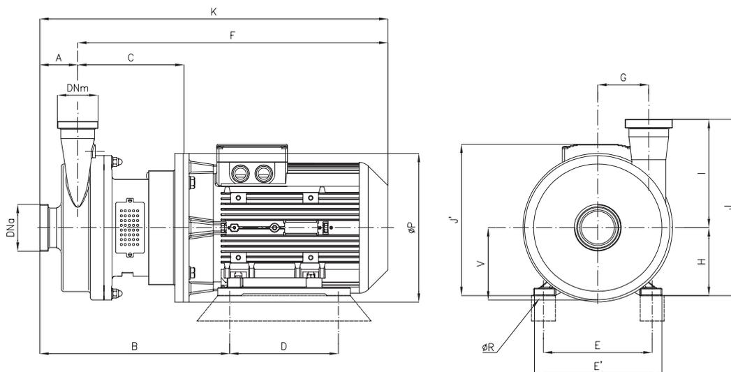
DN = Raccordo femmina DIN 11851 - Misure non impegnative - esec. con motori standard IEC/EN
