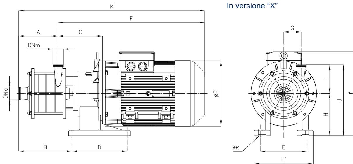
DN = Raccordo femmina DIN 11851 - Misure non impegnative - esec. con motori standard IEC/EN
