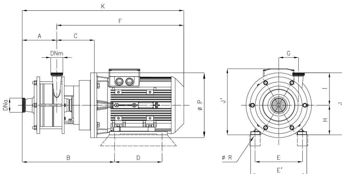
DN = Raccordo femmina DIN 11851 - Misure non impegnative - esec. con motori standard IEC/EN
