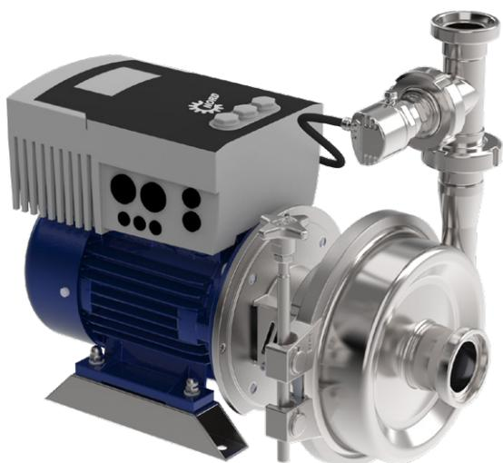
Application complète et fonctionnelle équipée d'un capteur de pression installé sur le refoulement de la pompe afin d'en moduler la vitesse en fonction de la valeur de pression relevée.
