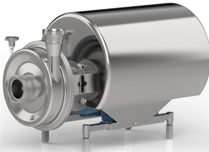
Esecuzione monoblocco interamente in acciaio inox con motore standard, albero con serraggio a compressione, tenuta interna e girante aperta. Grazie alla chiusura del corpo mediante morsetto sono facilmente smontabili per ispezioni, pulizia e manutenzione; inoltre la bocca di mandata può essere ruotata in ogni direzione. Carenatura di protezione per il motore.
